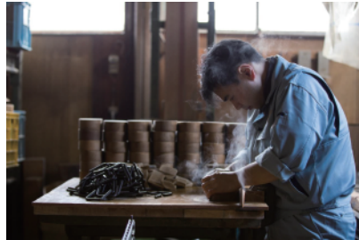
大館工芸社【秋田県】 1959年創業、製材、曲げ加工、桜皮縫い、底入れ、仕上げまで一環で行う。
