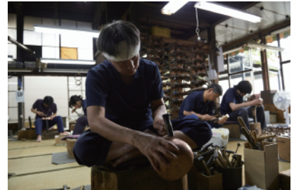
玉川堂【新潟県】 1816年創業、銅板を金槌で叩いて成形する鋳起銅器の技を継承。
